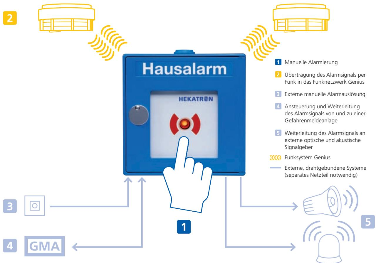
Der Funkhandtaster Genius hat trotz seiner kompakten Größe einiges zu bieten! Er kann als manueller Hausalarm und als Funk-Interface zu externen Systemen (z. B. Gefahrenmeldeanlagen, Sirene, Leuchten) eingesetzt werden. Im Brandfall wird der Alarm direkt per Funk in das Funknetzwerk Genius und/oder drahtgebunden an externe Geräte
